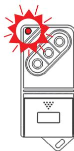
**ACHTUNG:** Permanentes Blinksignal während der Hauscodierung. Keine Identifikation der Gerätezahl, da die Funk-Fernsteuerung nur Senderfunktion besitzt.
