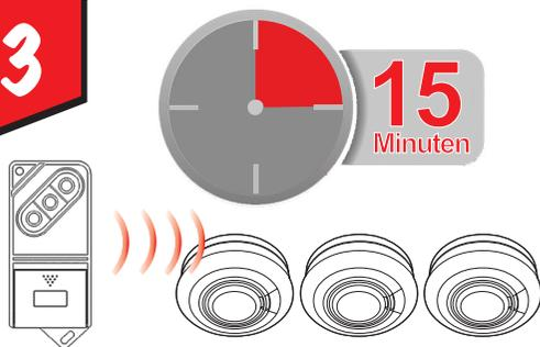
Ab jetzt steht ein Zeitfenster von 15 Minuten für die Vernetzung der Funk-Fernsteuerung mit den anderen Komponenten des Funksystems zur Verfügung.
