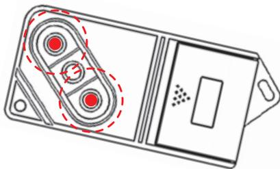
Gleichzeitiges Drücken von Test- und Ortungstaster, bis die rote LED aufleuchtet. Taster loslassen.
